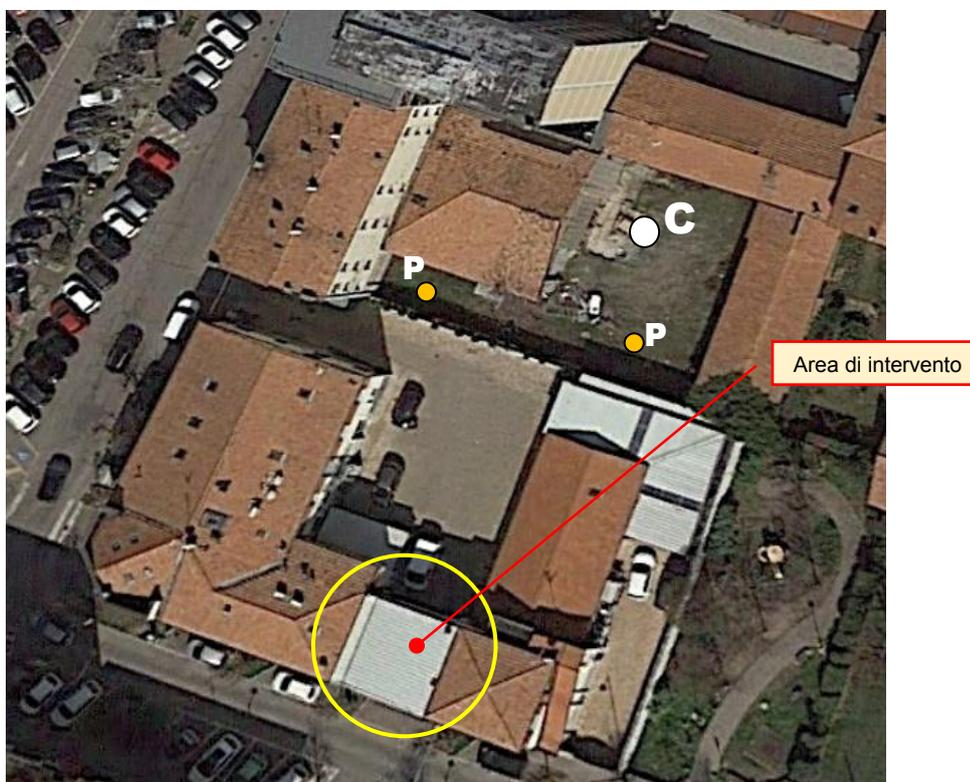
**Figura 2:** individuazione del carotaggio (C) e delle prove penetrometriche (P) effettuati a Nord della zona di intervento
